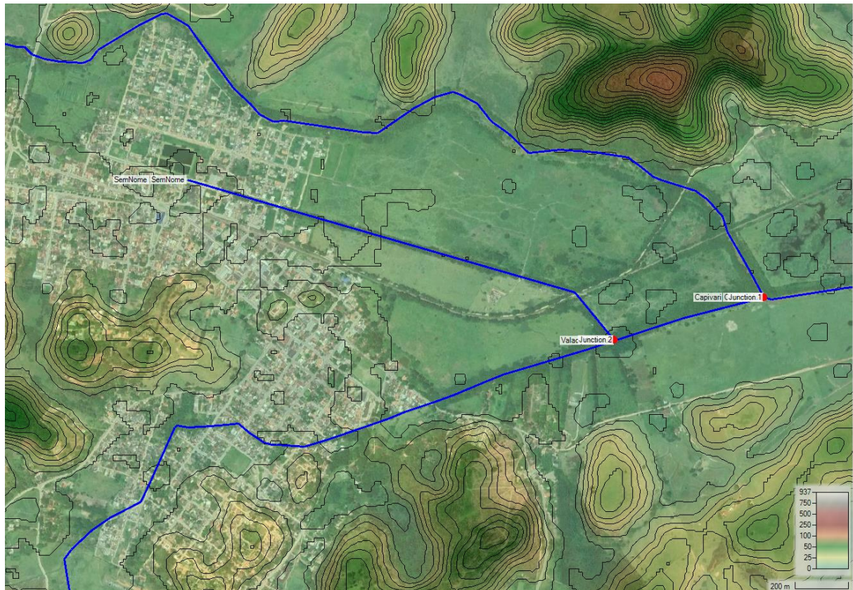
Figura 7. Curvas de nível do MDE ALOS/PALSAR com 12,5m de resolução espacial na região urbana do município de Silva Jardim, inserido no ambiente HEC-GeoRAS.
