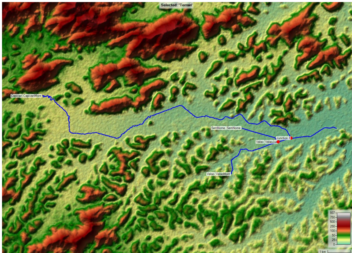
Figura 6. MDE ALOS/PALSAR com 12,5m de resolução espacial na região em estudo inserido no ambiente HEC-GeoRAS.
