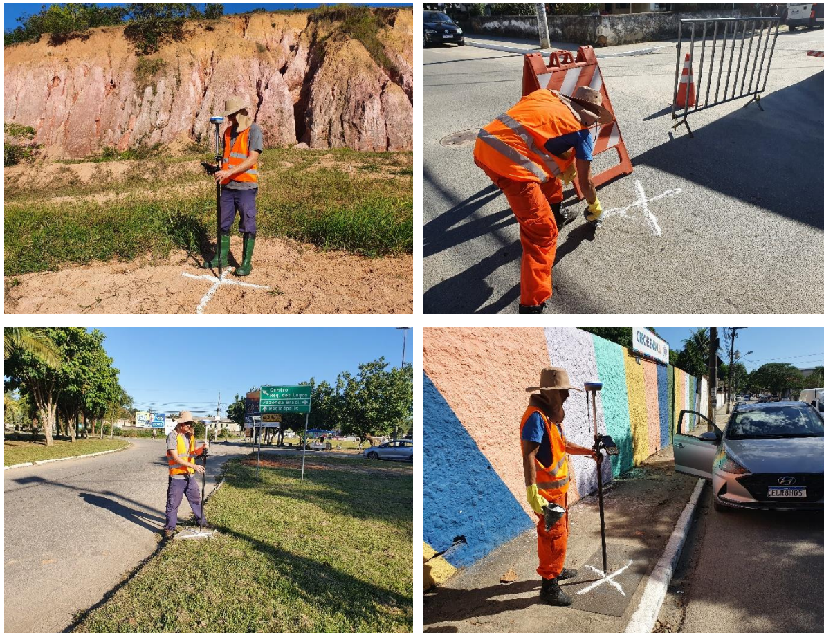
Figura 7. Marcação de pontos de amarração para georreferenciamento de precisão do modelo gerado pelas fotos com drone.
