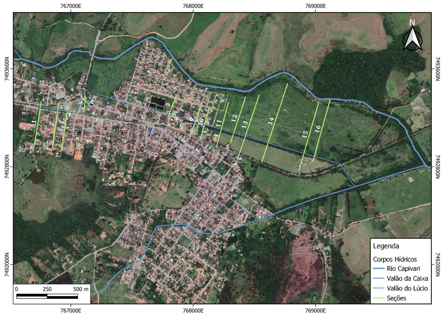
Figura 42. Localização das seções topobatimétricas realizadas no Valão do Lúcio, município de Silva Jardim, RJ.
