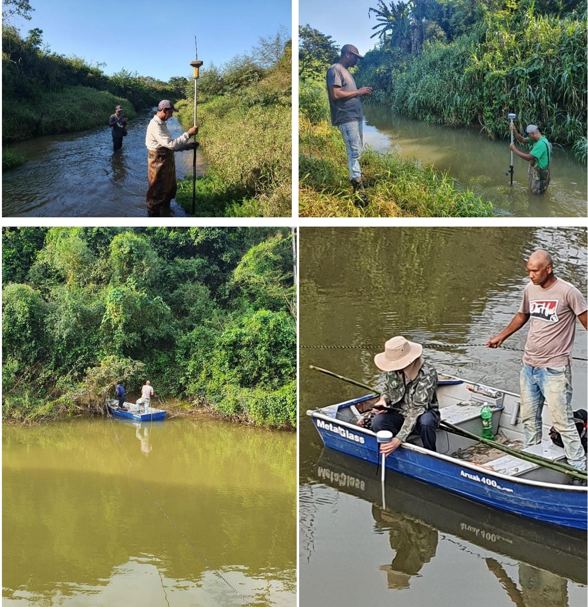
Figura 6. Levantamento da área molhada das seções feito a vau (linha superior) e a partir de embarcação (linha inferior).
