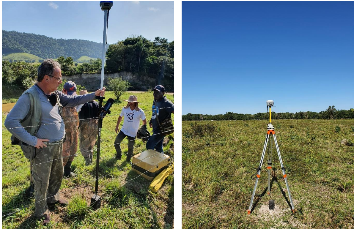
Figura 4. Marcos auxiliares instalados para levantamento da região do Rio Capivari à montante da cidade (esq.) e à jusante da cidade (dir.) de Silva Jardim.
