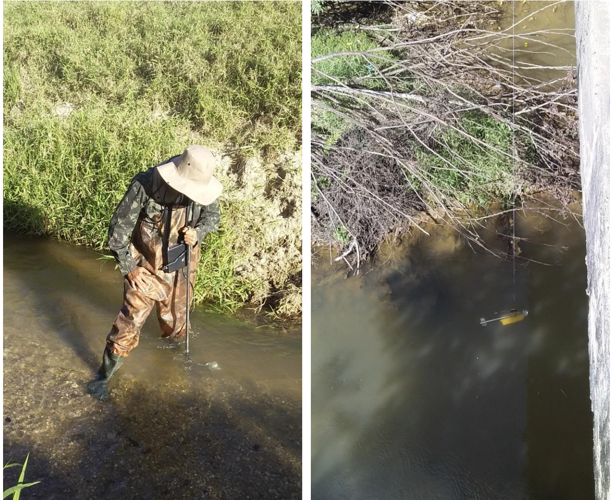
Figura 5. Medições de fluxo com molinete operado em haste a vau (esq.) e operado com guincho fluviométrico e lastro (dir.).
