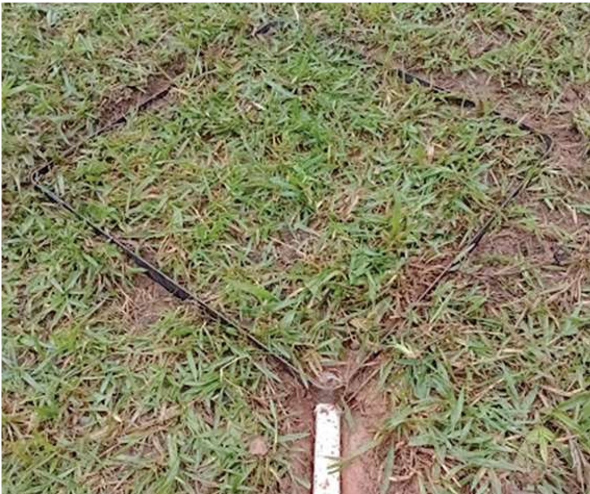
Figura 4: Barreira de contenção para coleta do escoamento superficial na PD.
