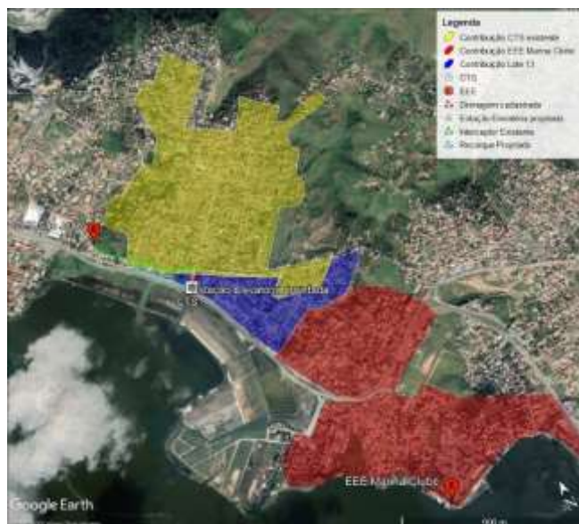
Figura 4 - Áreas de contribuição do interceptor existente
